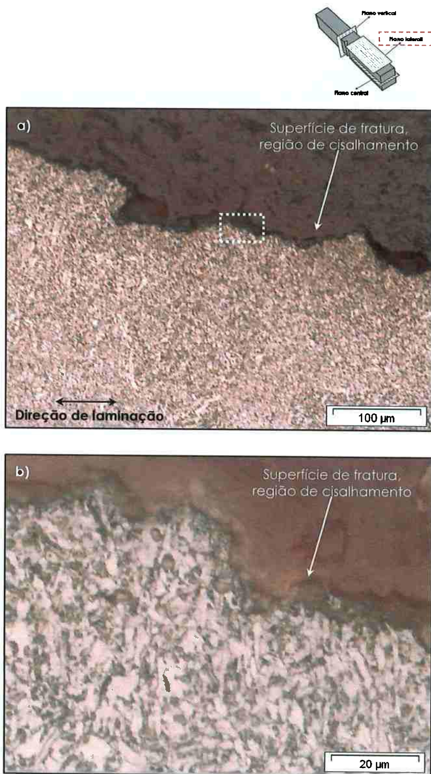
Figura 44 – Microestruturas no plano lateral da amostra com fratura mista, em região com predominância de fratura do tipo dúctil. Retirada da zona afetada termicamente do tubo. a) Microestrutura ferrítico-perlítica. MO; 200x; Nital 3%. b) Maior detalhe da região, indicando refino microestrutural e deformação plástica na superfície de fratura. MO; 1000x; Nital 3%.
