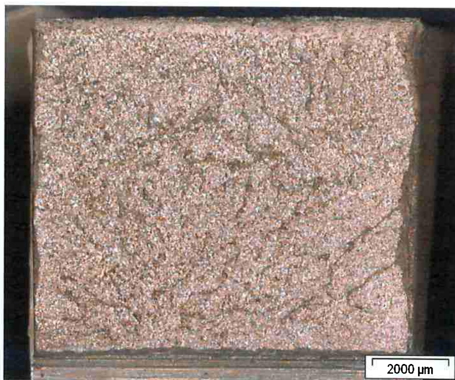
Figura 56 – Amostra com fratura frágil, obtida no ensaio Charpy. Superfície plana e isenta de deformação na região lateral e final da fratura. Energia absorvida no ensaio Charpy: 18J. Aumento: 8x. Lupa estereoscópica.
