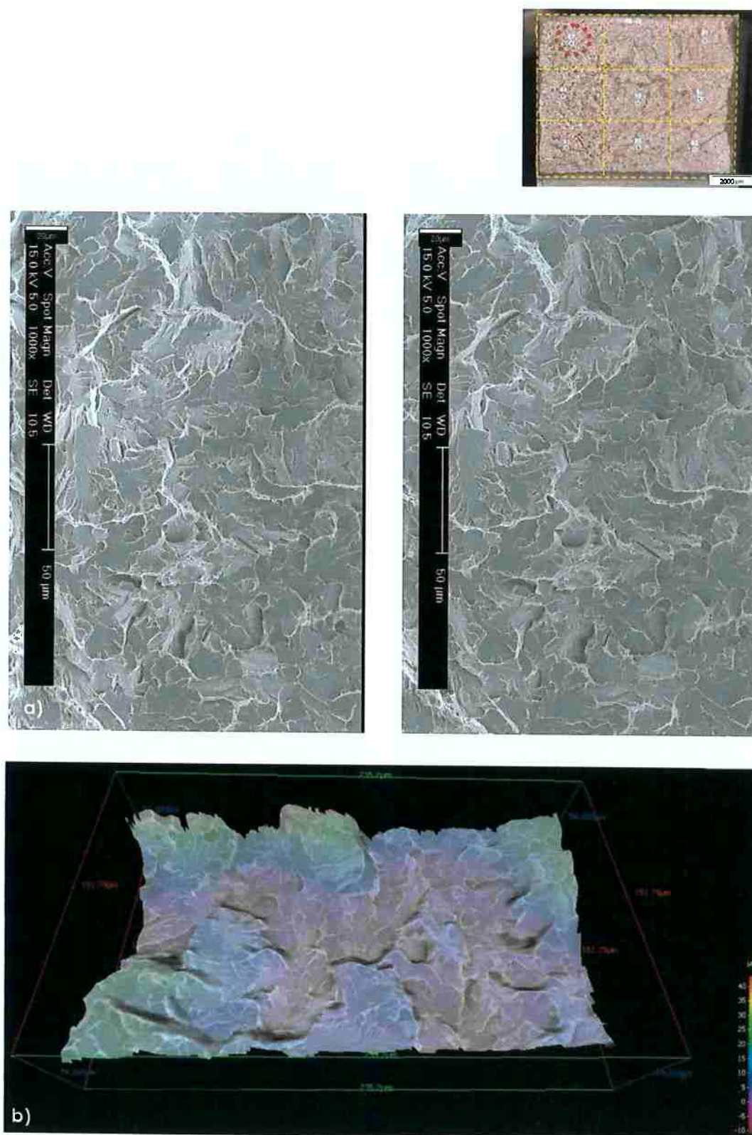
Figura 69 – Amostra com fratura frágil, região 7, predominando o mecanismo frágil com diversas facetas de clivagem. \Delta\theta = 10^\circ , 15 kV, MEV, 1000x. a) Par de imagens estereoscópica da região analisada. b) Dimensão fractal: 2.09. Área real sobre projetada: 1.47
